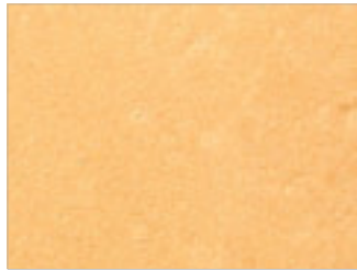
Enduit Aspect lissé
