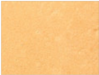
Enduit Aspect lissé
